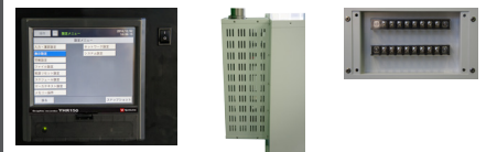
ペーパーレスレコーダ (組込型) YHR150 排気ダクト 外部出力端子
